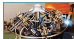
מהדקים פניאומטיים על מתקן חיתוך רובוטי להרכבת הגה מכונית
