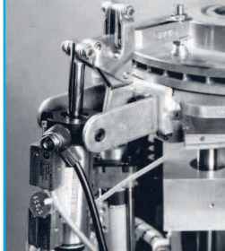
מודל 817-UF בדפנית דיסקים (של מעצורים) על מתקן הרכבה
